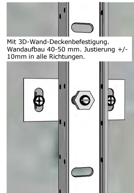
Vorschlag 2: Beschläge für Anschlusspaneel direkt an der Türzarge befestigt.
