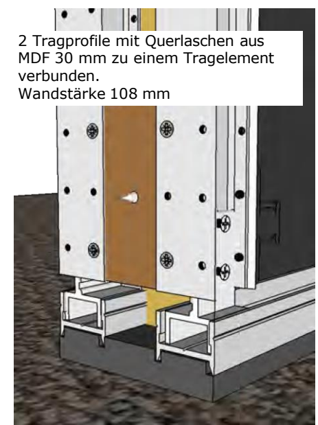
Boden-/Deckenprofile auf einem Unterbrett aus MDF 19 mm zusammengefasst. (Eingenutet und verschraubt)
