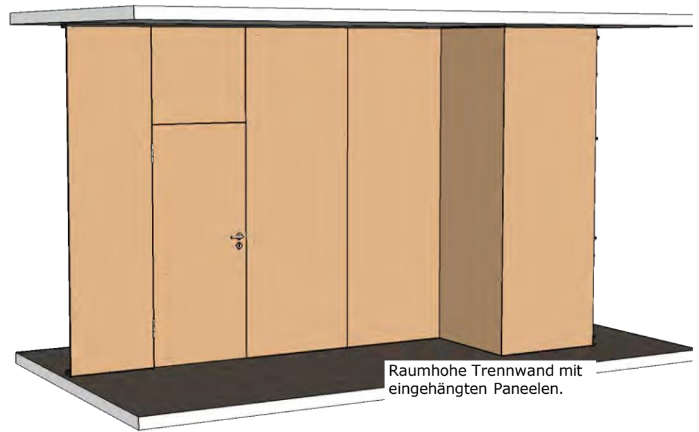
2 Tragprofile mit Querlaschen aus MDF 30 mm zu einem Tragelement verbunden. Wandstärke 108 mm
