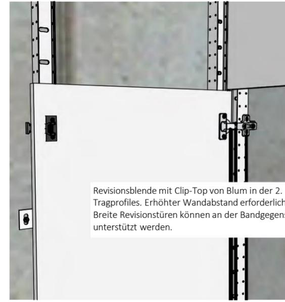
Revisionsblende mit Clip-Top von Blum in der 2. Lochreihe des Tragprofils. Erhöhter Wandabstand erforderlich! Breite Revisions Türen können an der Bandgegenseite mit Keku ASR unterstützt werden.
