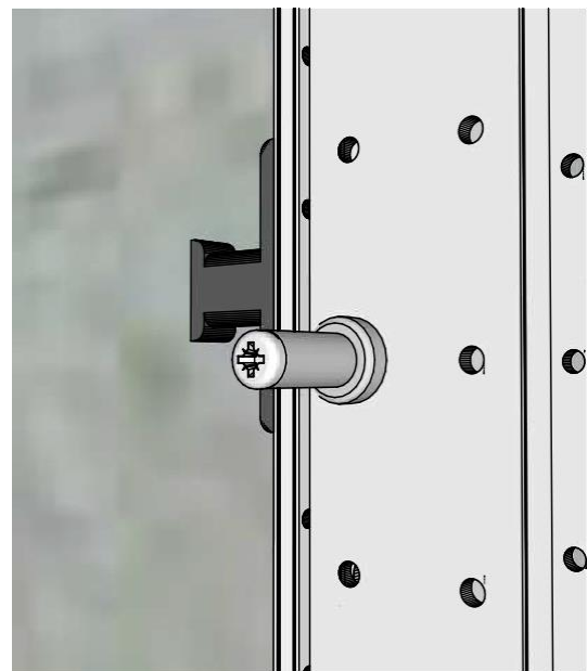
EH-M Rahmenteil besteht aus einem Tragbolzen und einer Systemschraube 4 x 25 Liko für Leichtmetall. EH-M Rahmenteil für Gleitpunkte.
