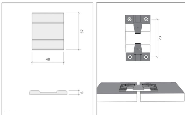
Das Material der Profile ist Aluminium T66, das Zubehör besteht aus Aluminium und Stahl. Das System umfasst alle Beschläge und Zubehörteile, die für eine Unterkonstruktion benötigt werden. Die Keku® Beschläge EH / EHS / EH-M und ASR sind speziell auf das Keku® R-System abgestimmt und ermöglichen eine reversible Befestigung der Verkleidungsplatten.
