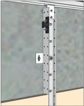
Das Material der Profile ist Aluminium T66, das Zubehör besteht aus Aluminium und Stahl.
